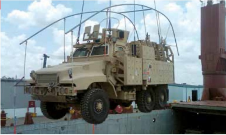
De Caiman MRAP. Boven type 1 en onder de verbeterde versie type 2. Hij wordt gebouwd op het onderstel van de FMTV (M1083) met LASC (Low Signature Armored Cab). Als je goed kijkt herken je deze gepantserde cabine tussen motorkap en laagbak.
