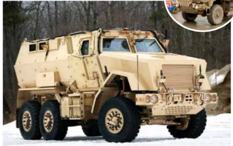
De Caiman MRAP. Boven type 1 en onder de verbeterde versie type 2. Hij wordt gebouwd op het onderstel van de FMTV (M1083) met LASC (Low Signature Armored Cab). Als je goed kijkt herken je deze gepantserde cabine tussen motorkap en laagbak.
