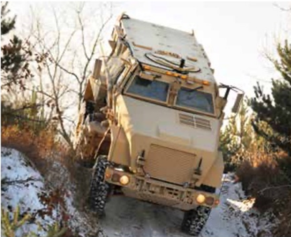
De Caiman MRAP. Boven type 1 en onder de verbeterde versie type 2. Hij wordt gebouwd op het onderstel van de FMTV (M1083) met LASC (Low Signature Armored Cab). Als je goed kijkt herken je deze gepantserde cabine tussen motorkap en laagbak.
