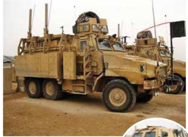
De Caiman MRAP. Boven type 1 en onder de verbeterde versie type 2. Hij wordt gebouwd op het onderstel van de FMTV (M1083) met LASC (Low Signature Armored Cab). Als je goed kijkt herken je deze gepantserde cabine tussen motorkap en laagbak.
