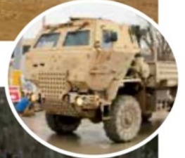
De Caiman MRAP. Boven type 1 en onder de verbeterde versie type 2. Hij wordt gebouwd op het onderstel van de FMTV (M1083) met LASC (Low Signature Armored Cab). Als je goed kijkt herken je deze gepantserde cabine tussen motorkap en laagbak.
